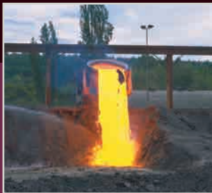
Ausgießen der Konverter- schlacke, Foto: Reinhard Thielsch
