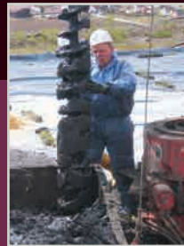
Bohrungen an den Schlammteichen 3, 4 und 5 (2007). Die Bohrkern wurden analysiert.
