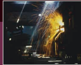
Blasen des OBM-Konverters (Oxygen-Bodenblasen-Maxhütte), ab 1970
