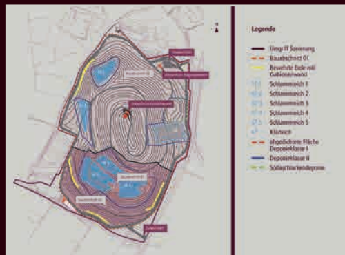
Sofortmaßnahmen ab Oktober 2005: Stützfußschüttung an der Südböschung, Umzäunung des Geländes sowie Neubau von Elektrizitätsversorgung und Sickerwasserreinigung
