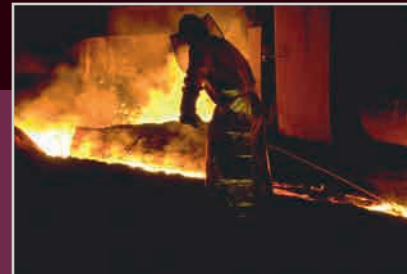
Alle zwei Stunden wurde der Hochofen abgestochen
