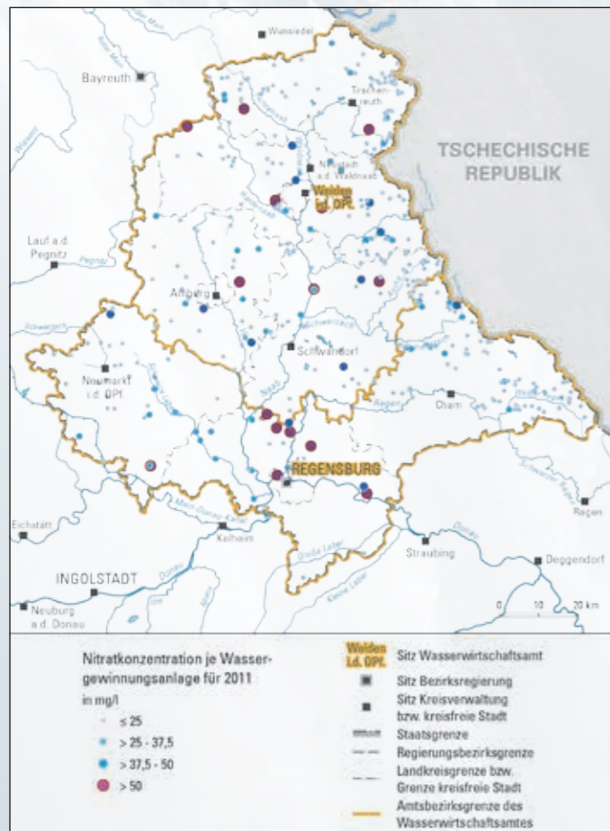
▲ Grafik 3: Nitratbelastung des Rohwassers in der Oberpfalz je Wassergewinnungsanlage im Jahr 2012 (WVB OPf., Karte 11 Seite 54)
