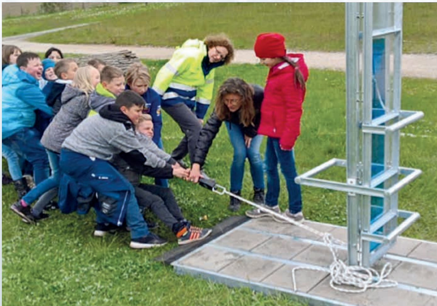
▲ Weltwasserwoche 2017: Ein neues Modell des WWA Regensburg zur Veranschaulichung des Wasserdruckes wird getestet: Die tatkräftigen Schüler erfahren wie verhängnisvoll Wasser sein kann. Ein niedriger Wasserstand hinter der Tür bewirkt, dass man die Tür nicht mehr aufbringt. Dies ist die Hauptursache für Todesfälle bei denen die Opfer durch Hochwasser eingeschlossen wurden. (Foto: WWA WEN)
