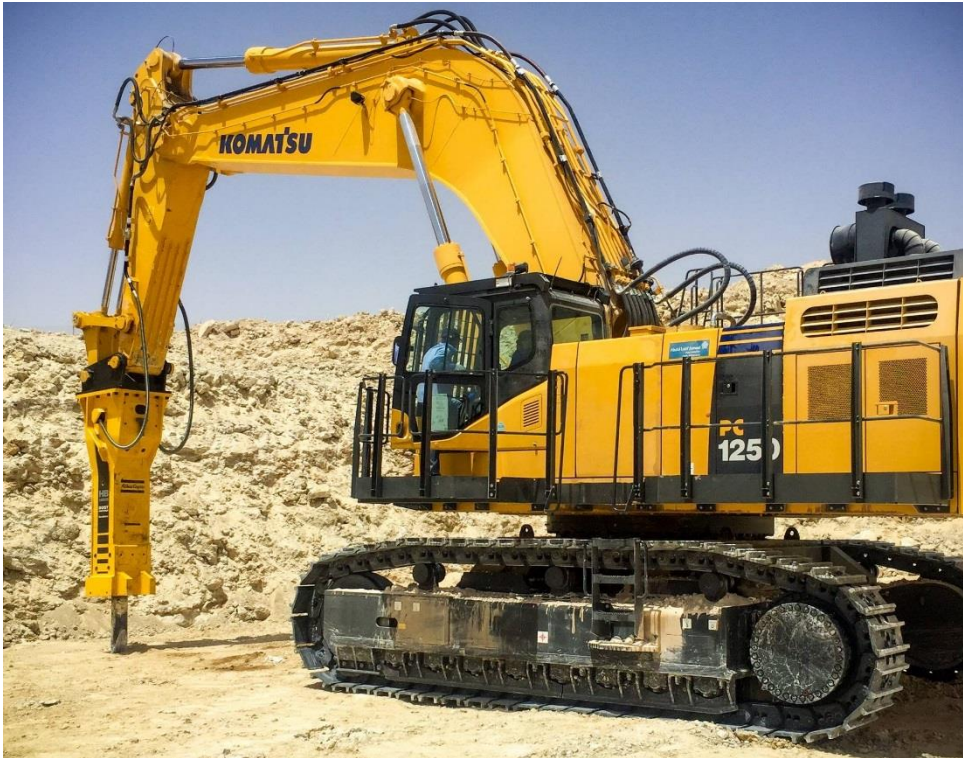
Abbildung 2.1: Bagger mit Meißelaufsatz (Hydraulikhammer)
