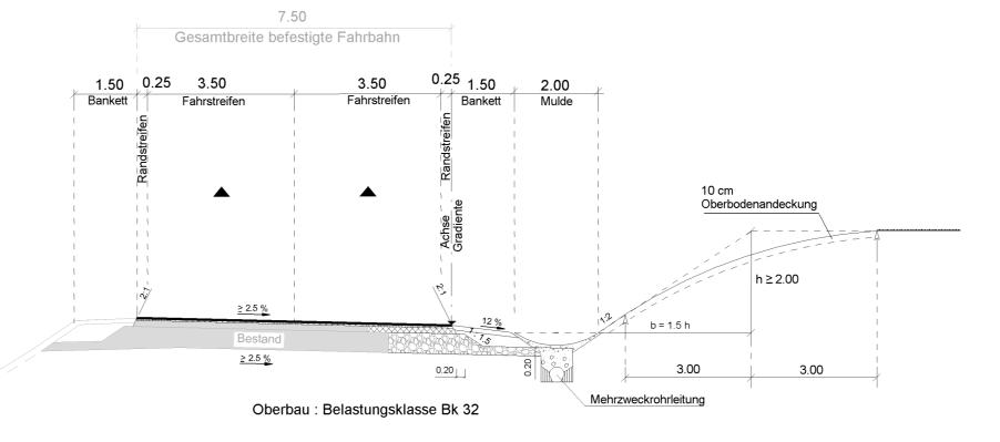
Böschungen gemäß RAA (Richtlinie für die Anlage von Autobahnen)
