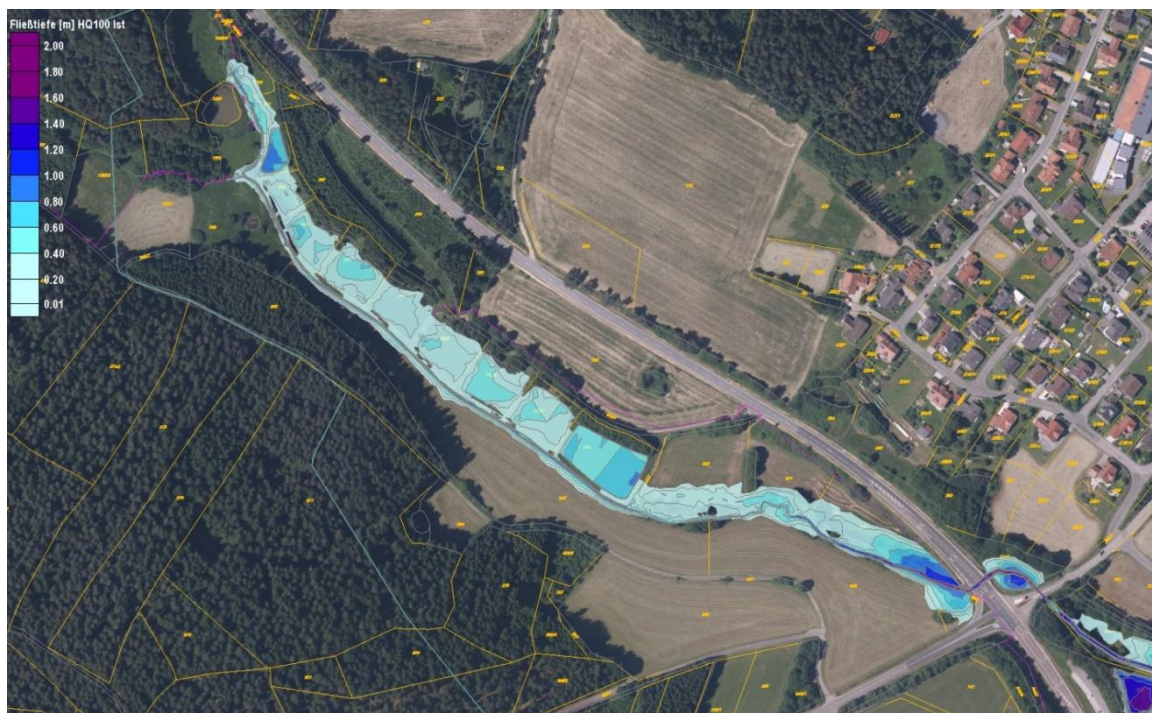
Abbildung 1.2: Fließtiefendarstellung [m] Bestand im Gewässerabschnitt oberstrom.
