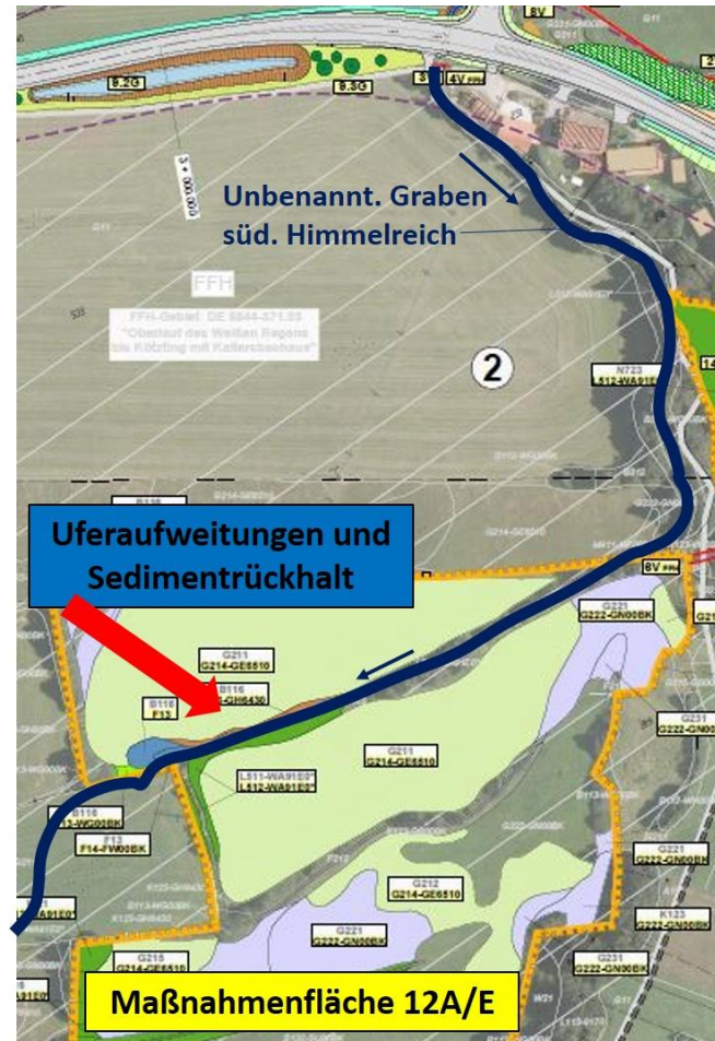
Abb. 2: Naturnaher Gewässerausbau am unbenannten Graben südlich Himmelreich – punktuelle Uferaufweitungen zum Sedimentrückhalt
