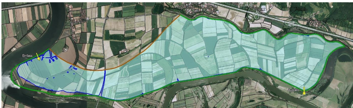
Abbildung 6-1 Polderumgriffe Wörthhof (oben W4, unten W6)
