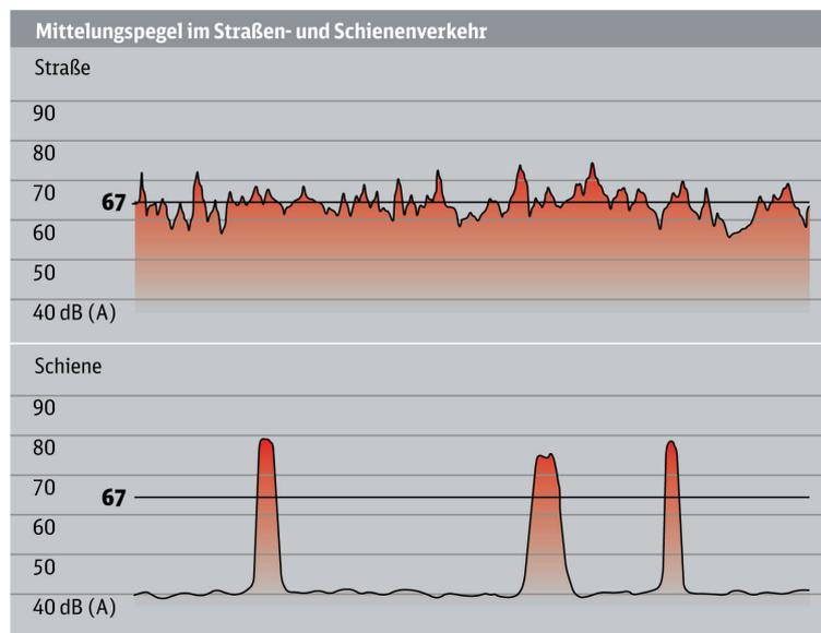
Die Grafik links verdeutlicht den Unterschied im charakteristischen zeitlichen Verlauf von Straßen- und Schienenlärm bei gleichem Mittelungspegel. In der 16. Bundesimmissionsschutzverordnung (16. BImSchV), die für die Dimensionierung von Schallschutzmaßnahmen im Rahmen der Lärmvorsorge maßgeblich ist, wurde diesem Umstand Rechnung getragen und die geringere Lästigkeitswirkung des Schienenverkehrs in Form des so genannten „**Schienebonus**“ mit einem Wert von 5 dB (A) verankert.
