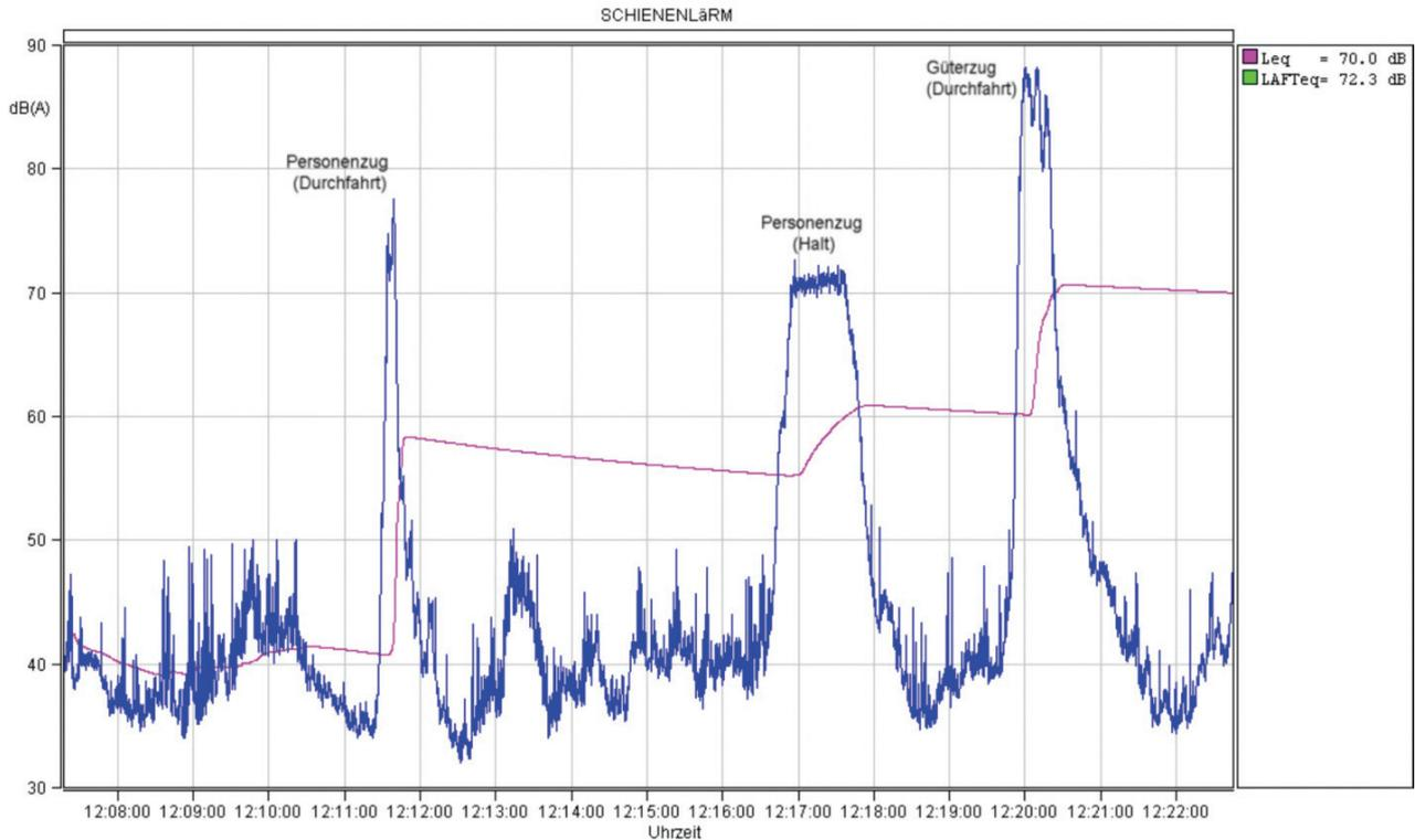
Dieses Diagramm zeigt den stetigen Anstieg des energieäquivalenten Dauerschallpegels im Verlauf der Messung. Beginnend mit etwa 43 dB(A) am Beginn der Messung nimmt der energieäquivalente Dauerschallpegel deutlich zu und baut sich in Zeiten geringerer Immissionswerte jeweils nur langsam wieder ab. Würde die vorliegende Messdauer von ca. 16 min auf einen längeren Zeitraum ausgedehnt, würde sich die rosa Kurve etwa im Bereich um 70 dB(A) einpegeln.
