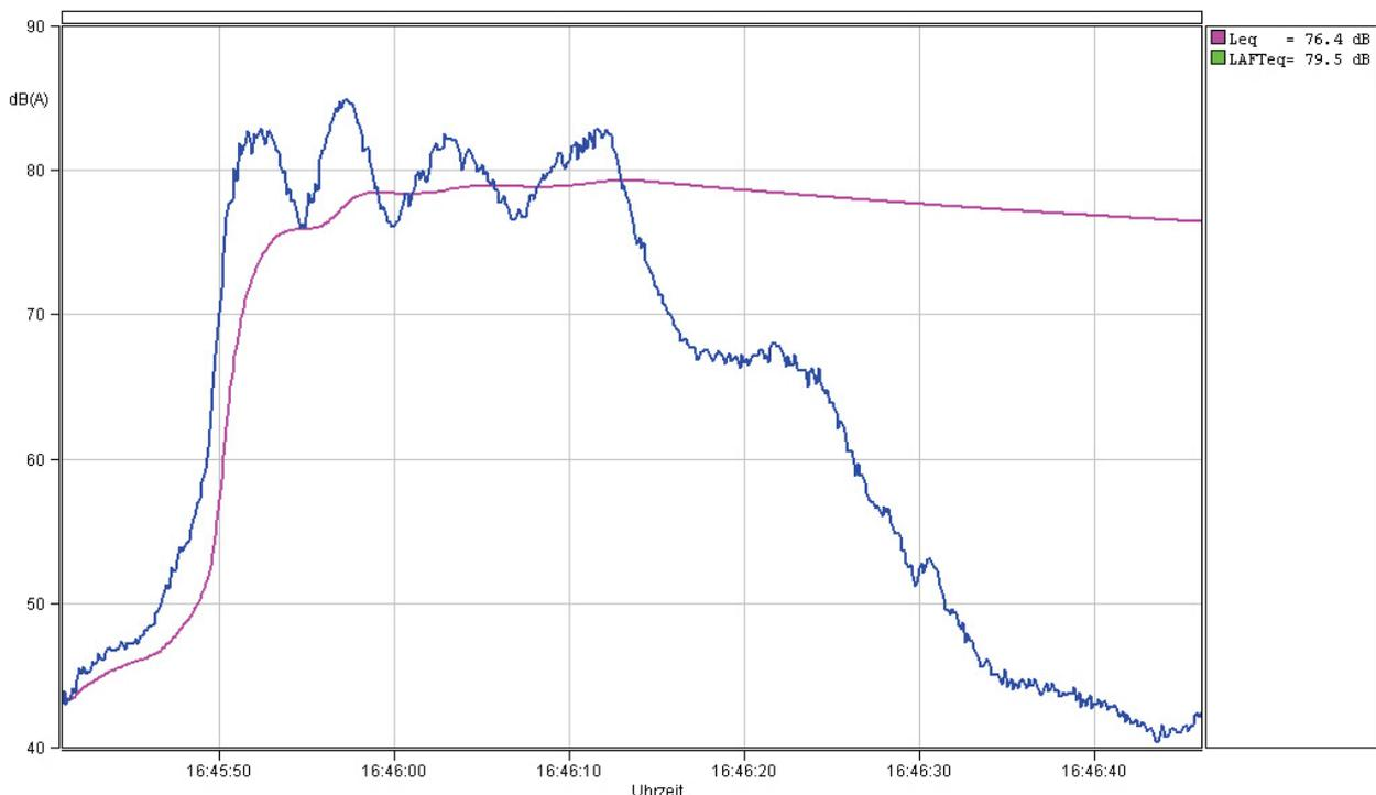
Beispiel für einen in ca. 20m Entfernung vorbeifahrenden Güterzug. Die blaue Kurve gibt den aktuellen Schalldruckpegel wieder. Mit dem rosa Kurvenverlauf wird der energieäquivalente Dauerschallpegel dargestellt, mit dem das schwankende Geräusch dem Pegel einem gleichbleibenden Dauergeräusch mit identischem Energieinhalt gleichgesetzt werden kann.
